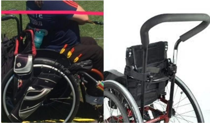
図21：車いすの背面に直接装着されていないプッシュハンドル
